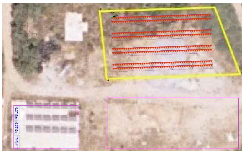
Εικόνα 19 Ι.Μ. Δοχειαρίου Χωροθέτηση Φ/Β Εγκατάστασης
