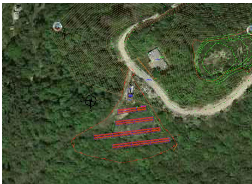
Εικόνα 17 Ι.Μ. Ζωγράφου Χωροθέτηση Φ/Β Εγκατάστασης
