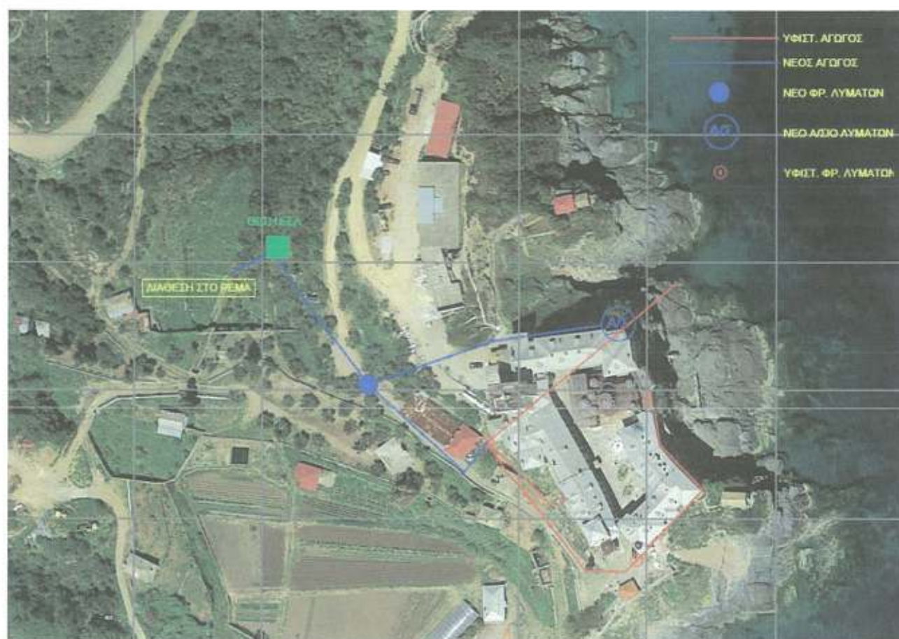
Σχήμα 2.1: Χάρτης προτεινόμενων έργων: Οι καφέ γραμμές αποτυπώνουν τους υφιστάμενους αγωγούς ακαθάρτων ενώ η μπλε γραμμή αποτυπώνει την όδευση των νέων αγωγών ακαθάρτων
