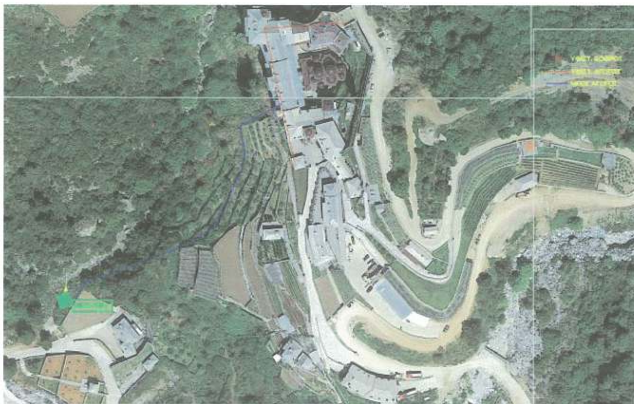
Σχήμα 2.1: Χάρτης προτεινόμενων έργων: Οι καφέ γραμμές αποτυπώνουν τους υφιστάμενους αγωγούς ακαθάρτων ενώ η μπλε γραμμή αποτυπώνει την όδευση των νέων αγωγών ακαθάρτων
